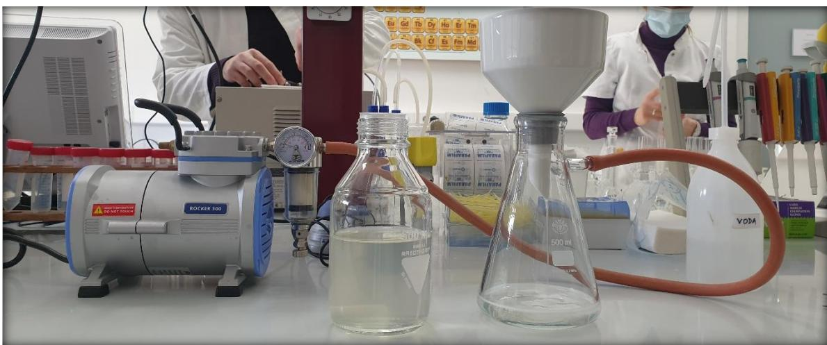
Slika 3.1.1. Filtracija pomoću vakuumske pumpe i Büchner lijevka
