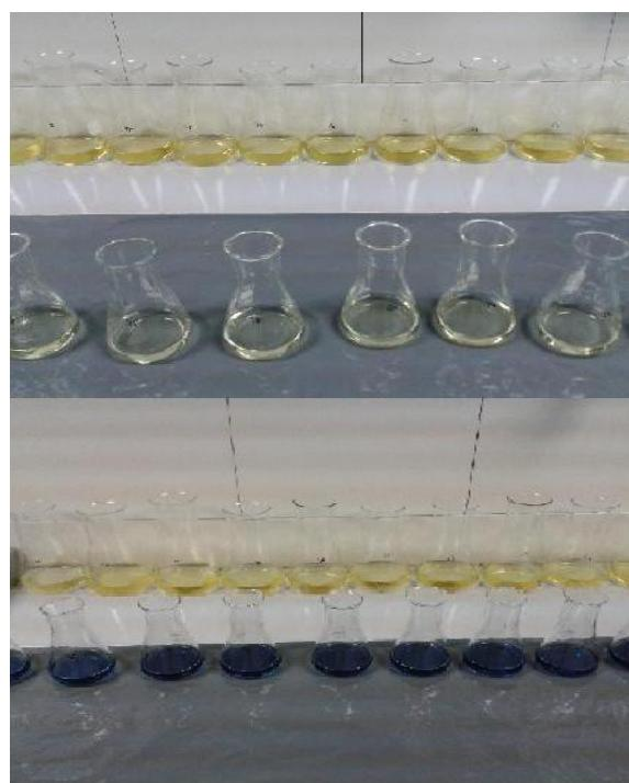
Slika 4. Uzorci pripremljeni za analiziranje količine fosfora
