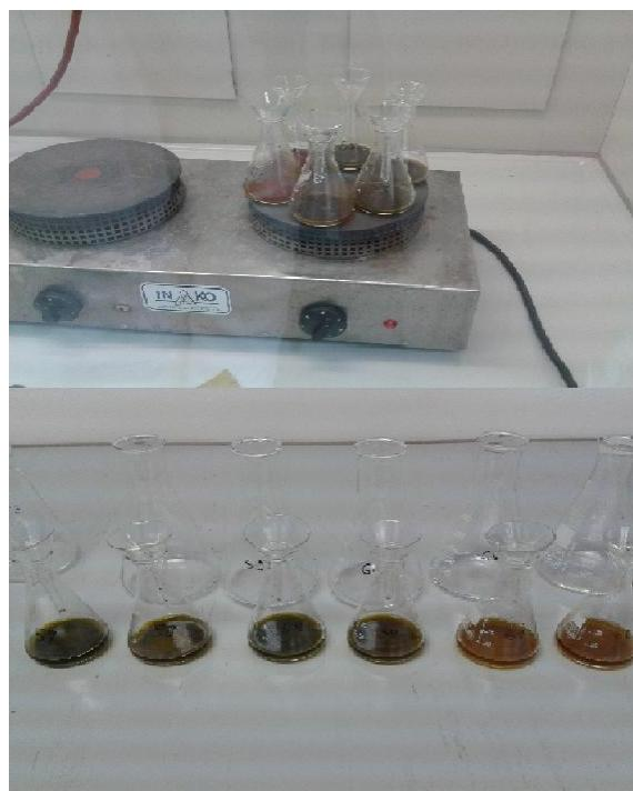
Slika 3. Uzorci tla pripremljeni za određivanje humusa
