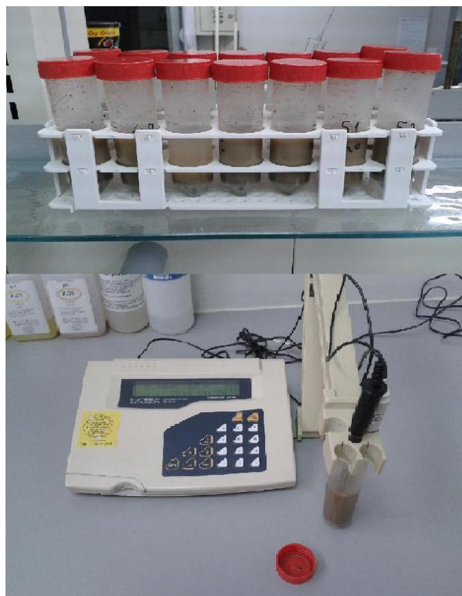
Slika 2. pH metar i uzorak tla
