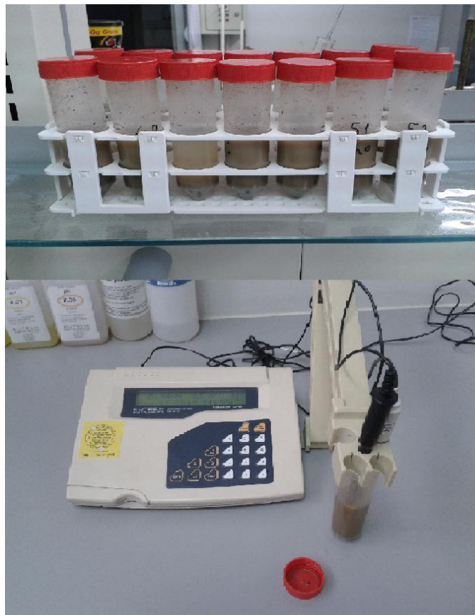
Slika 2. pH metar i uzorak tla (snimio Marko Mumelaš)
