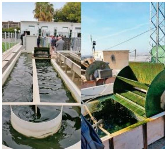
Slika 2.2.2.1. Bioreaktori otvorenog tipa.
