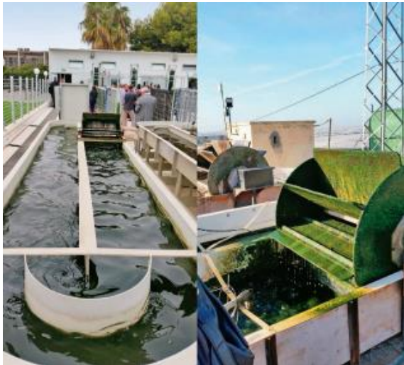
Slika 2.2.2.1. Bioreaktori otvorenog tipa. Izvor: Bosak (2017).
