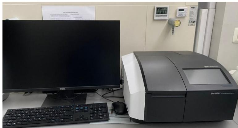
Slika 3.5.3. Spektrofotometar SHIMADZU UV-1900i
