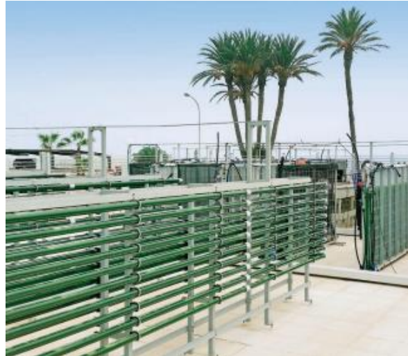
Slika 2.2.2.2. Zatvoreni fotobioreaktori. Izvor: Bosak (2017.)
