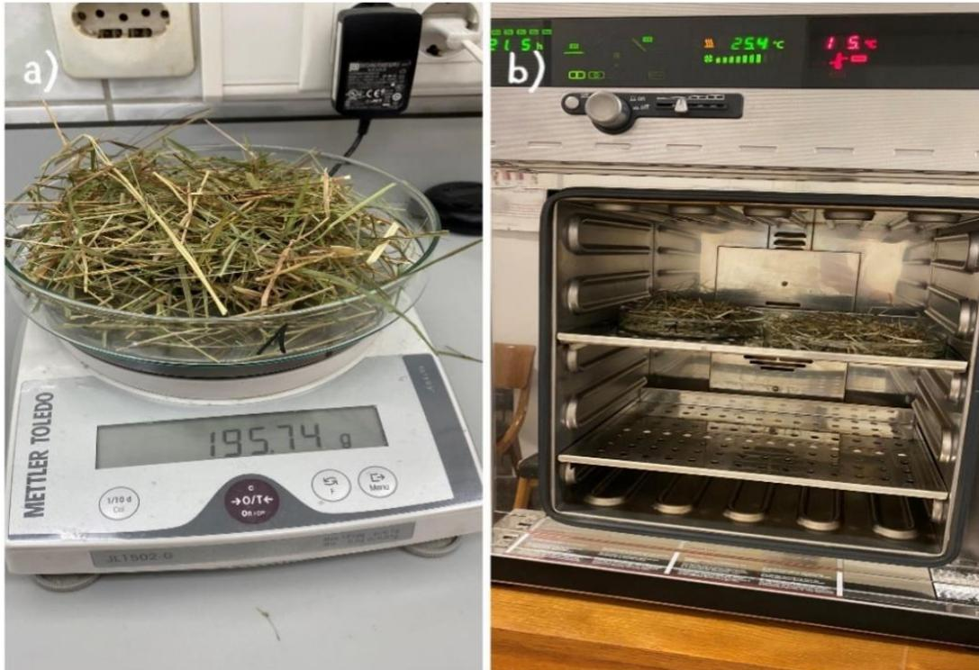
Slika 3.1.2. Vaganje (a) i sušenje (b) sijena za određivanje suhe tvari (vlastiti izvor)
