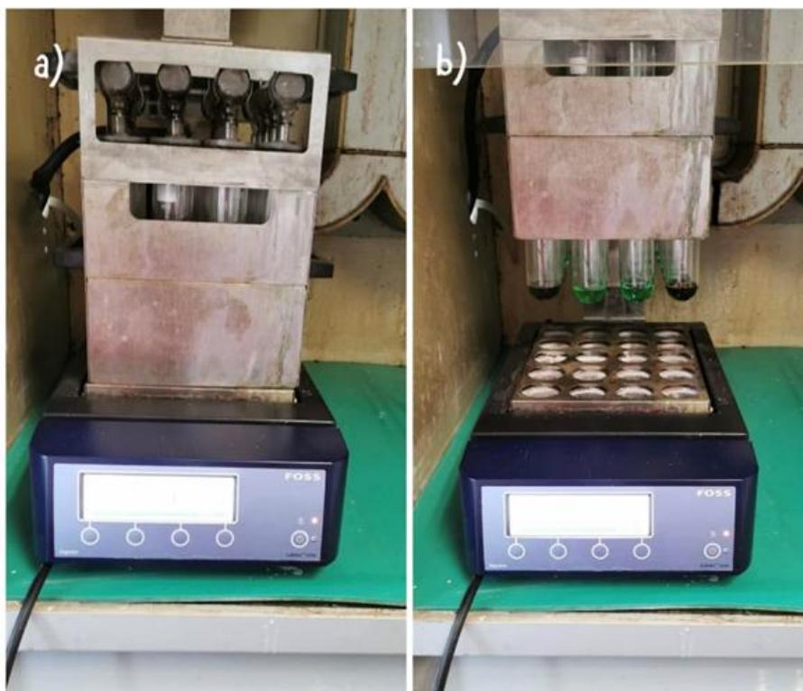
Slika 3.1.3. Spaljivanje uzorka na bloku (a) razgrađeni uzorci prije destilacije (b)
