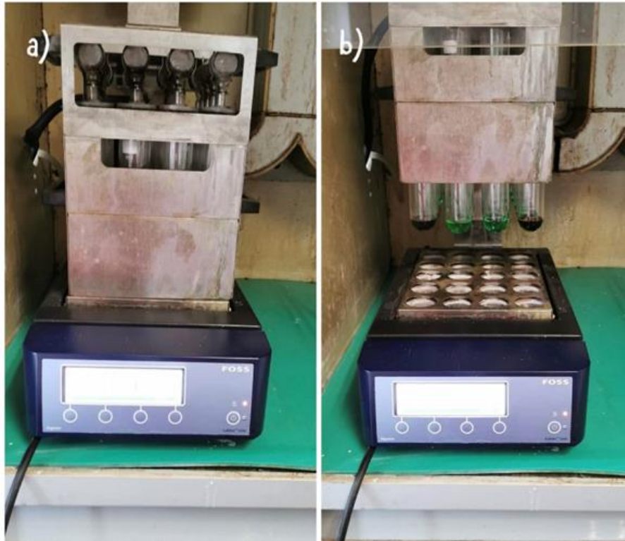
Slika 3.1.3. Spaljivanje uzorka na bloku (a) razgrađeni uzorci prije destilacije (b) (vlastiti izvor)
