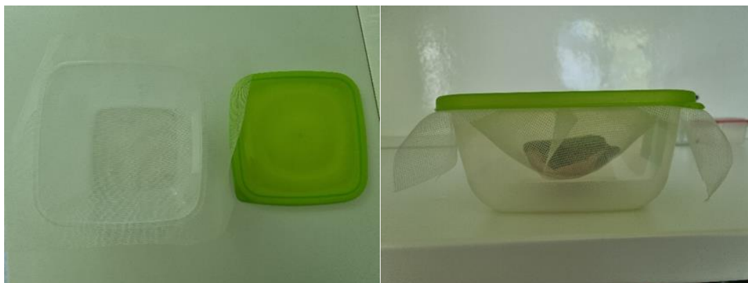
Slika 4.3.1. Posuda s mrežicom pripremljena za odmrzavanje uzoraka i uzorak postavljen za odmrzavanje
