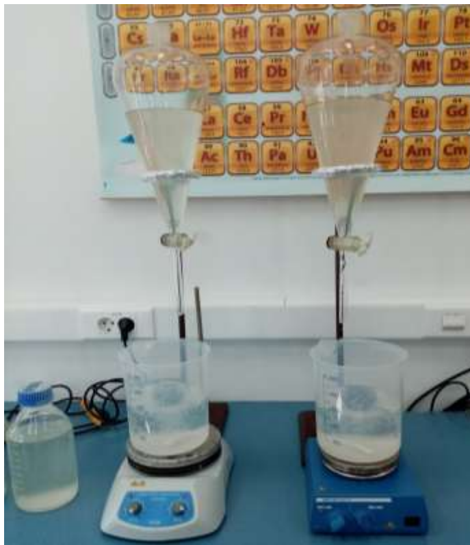
Slika 5. Priprava mikrokapsula pomoću lijevka za odjeljivanje
