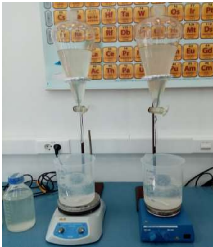
Slika 5. Priprava mikrokapsula pomoću lijevka za odjeljivanje
