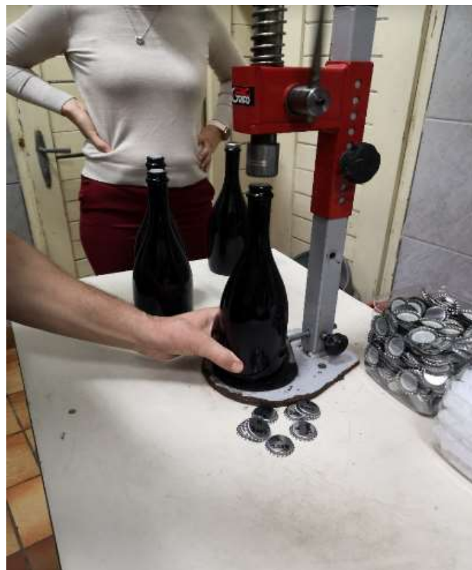
Slika 2.5. Postavljanje krunskih čepova Izvor: Šikač I.
