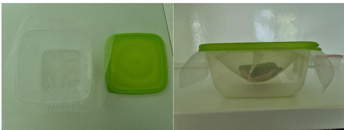
Slika 4.4.1. Prazna posuda sa mrežicom korištena i uzorak na mrežici u zatvorenoj posudi pripremljen za odmrzavanje
