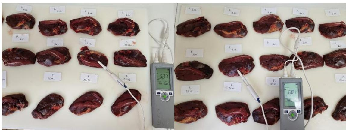
Slika 4.5.1. Mjerjenje pH vrijednosti uzorka prsnog mišića divlje patke gluhare
