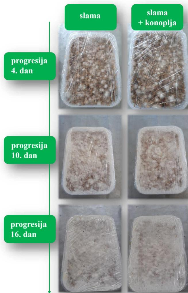
**Slika 10.** Prikaz progresije proraštanja micelija u kalupima
