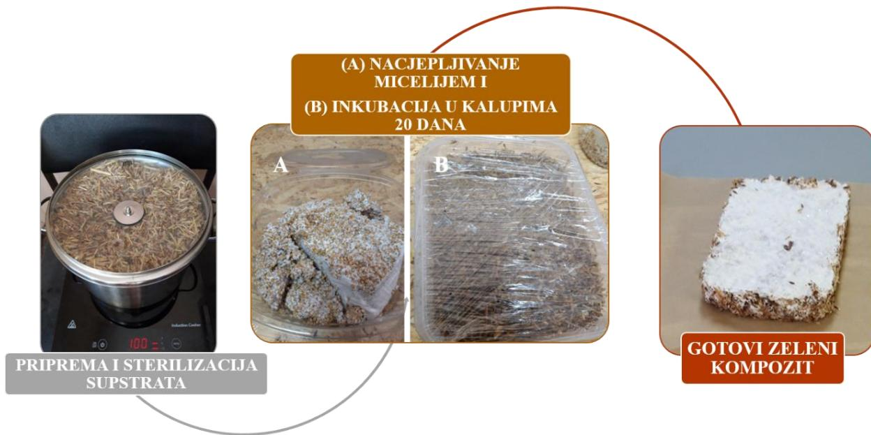
**Slika 7.** Shematski prikaz postavljanja eksperimenta
