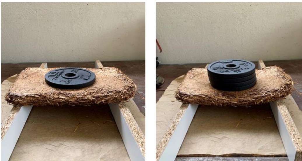
Slika 24. Prikaz testiranja čvrstoće vruće prešanog uzorka ustupljenog od OPG Tucman
