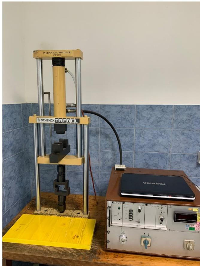
**Slika 26.** Kidalica za provođenje testa savojne čvrstoće
