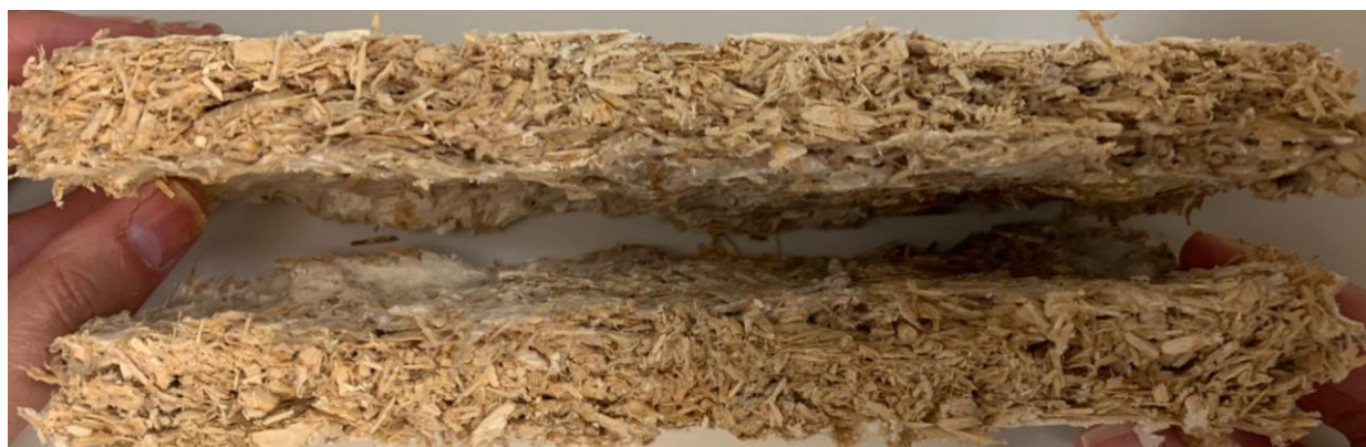
Slika 25. Prikaz poprečnog presjeka kompozita pripremljenog za testiranje savojne čvrstoće
