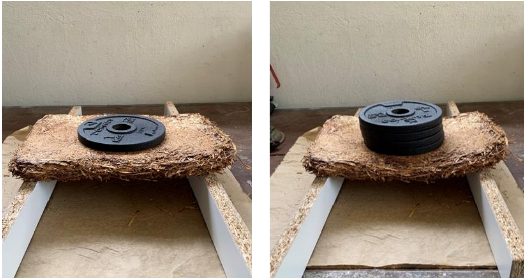
Slika 24. Prikaz testiranja čvrstoće vruće prešanog uzorka ustupljenog od OPG Tucman
