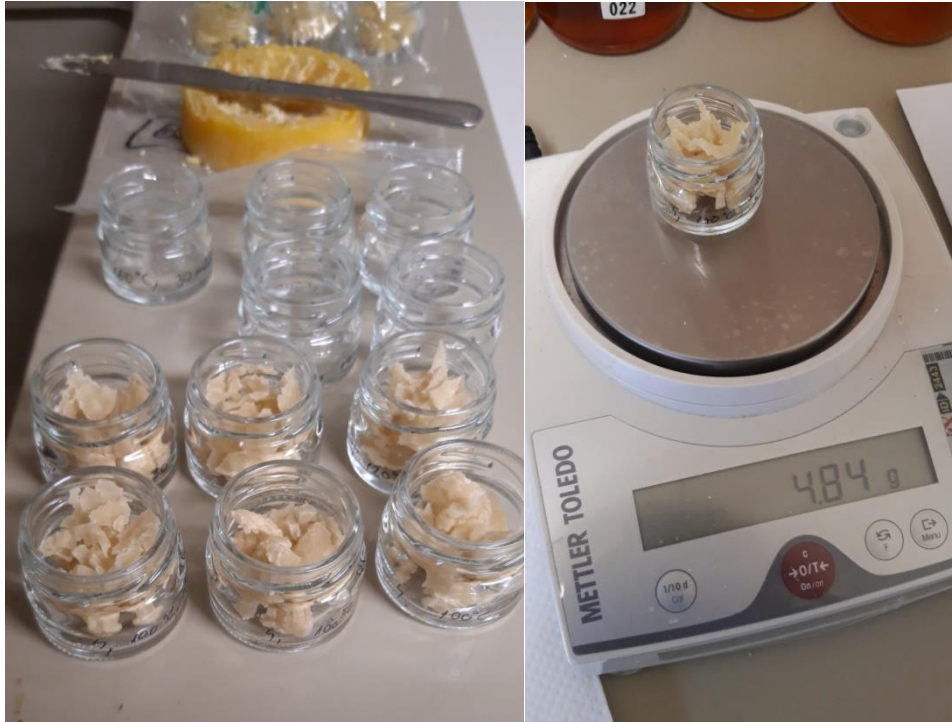
Slika 3.1. i 3.2. Vaganje uzoraka pčelinjeg voska
