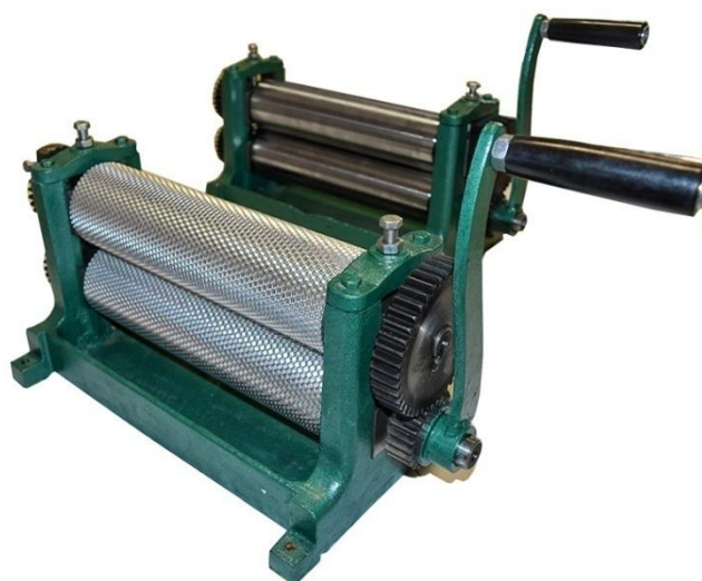
Slika 2.7. Valjak za izradu satnih osnova
