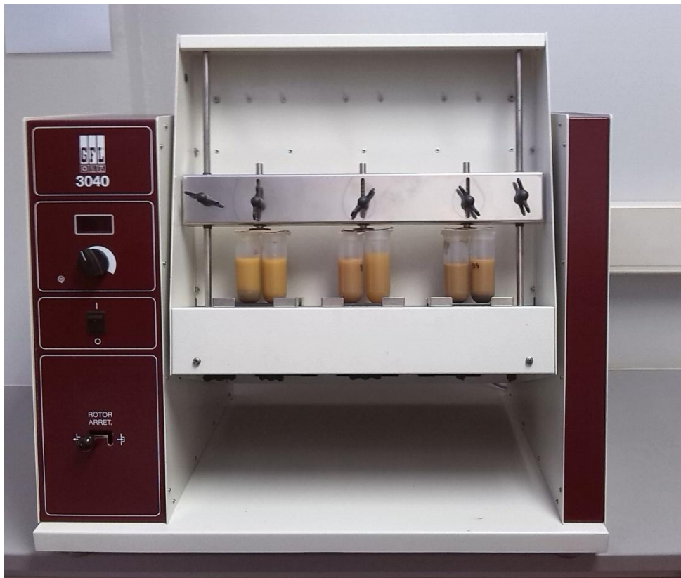
Slika 8: Mućkalica za uzorke GFL 3040
