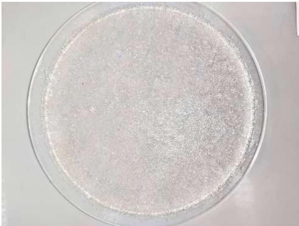
Slika 3.3.2.1. Mikrosfere nanese na Petrijevu zdjelicu nakon filtriranja i ispiranja
