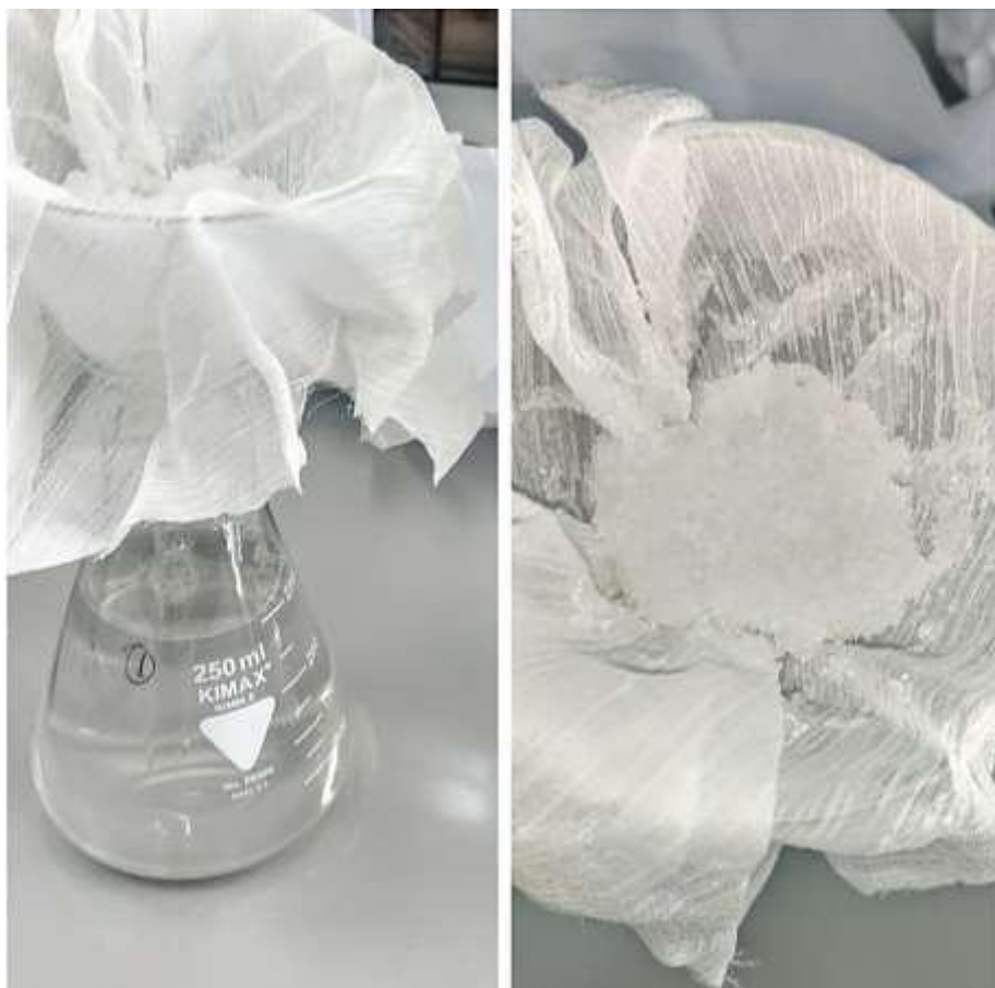
Slika 3.3.1.1. Odstranjivanje mikrosfera filtriranjem
