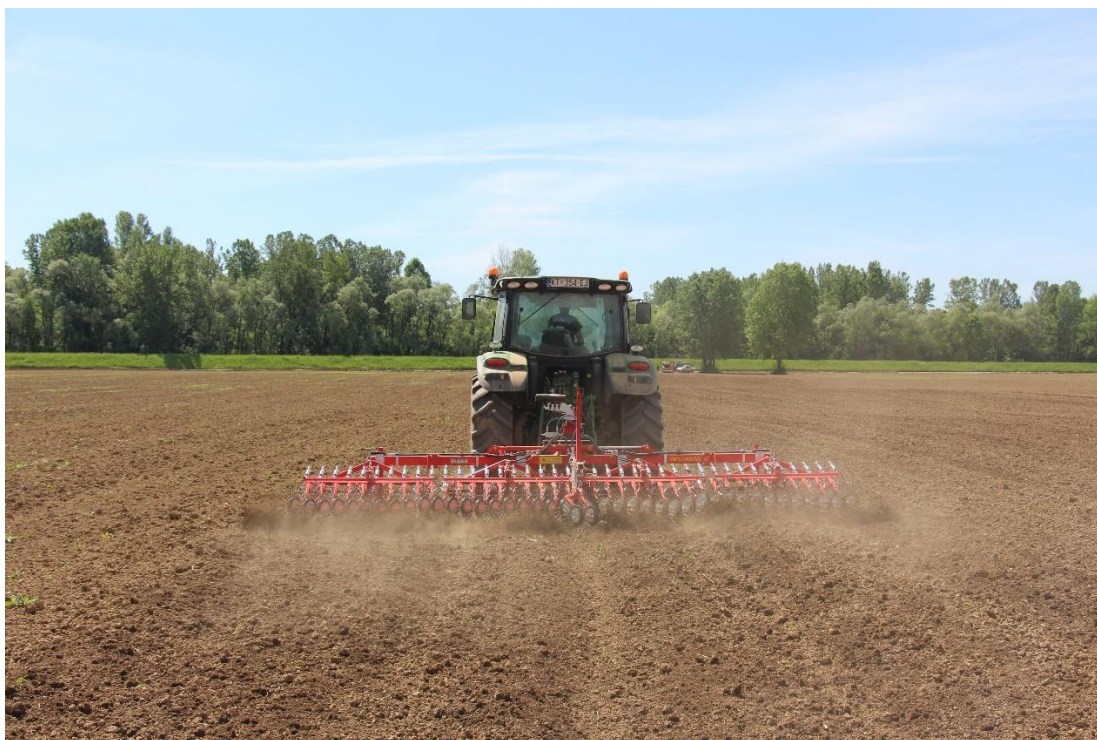
Slika 3.2.1. Mehanička obrada tla roto-„štriglom“ neposredno pred sjetvu soje.
