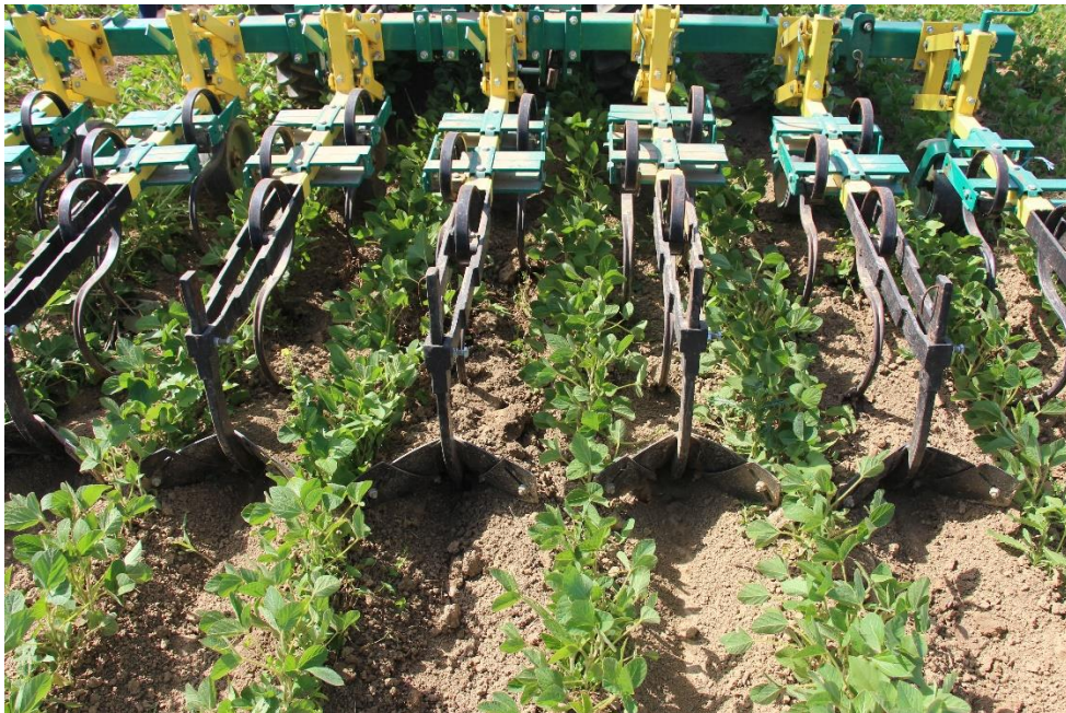
Slika 2.4.3.1. Međuredni kultivator UMK 8 sa ogrtačima.
