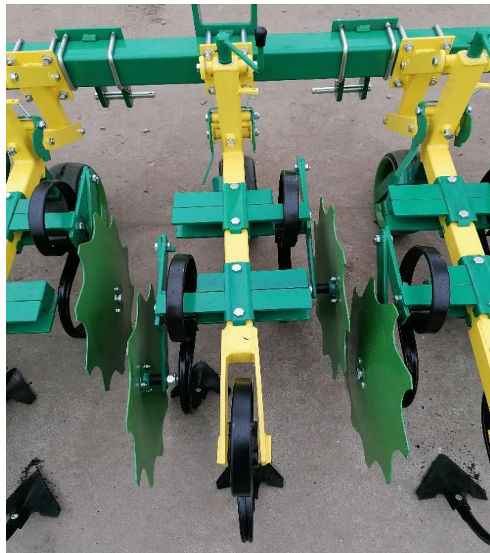
Slika 3.2.2. Izgled radnih tijela (motičice) i širina zaštitne zone kod međuredne kultivacije.
