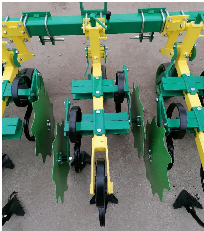
Slika 3.2.2. Izgled radnih tijela (motičice) i širina zaštitne zone kod međuredne kultivacije.
