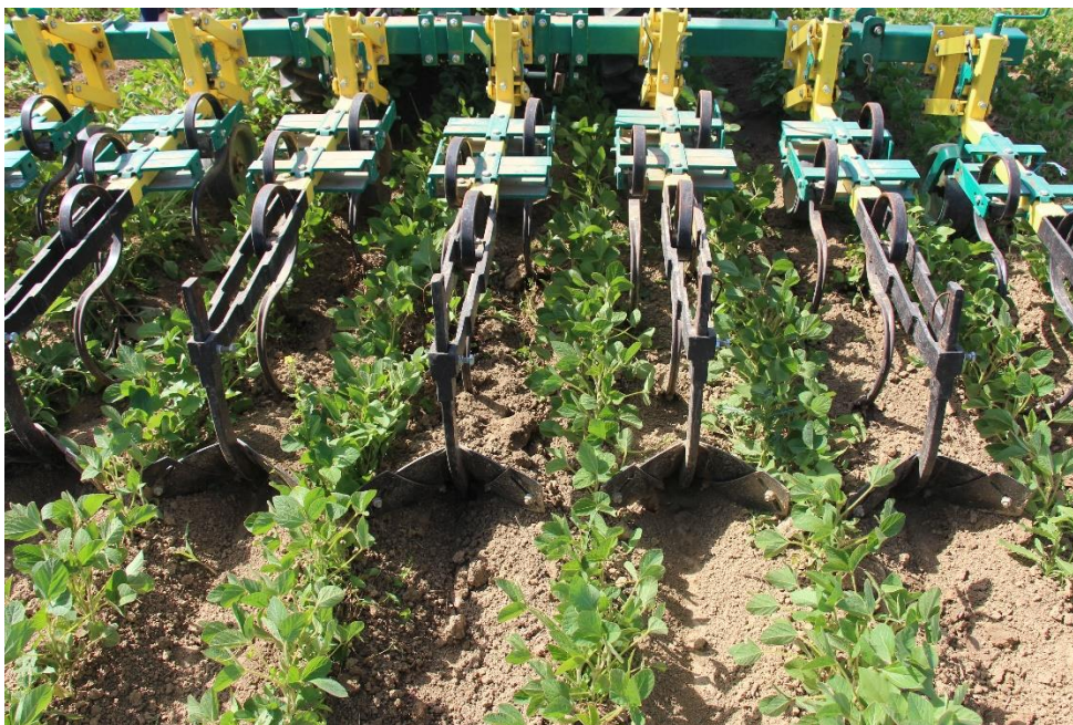
Slika 2.4.3.1. Međuredni kultivator UMK 8 sa ogrtačima.
