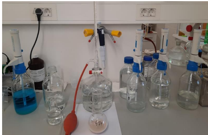
Slika 3. Aparatura za određivanje reducirajućeg šećera
