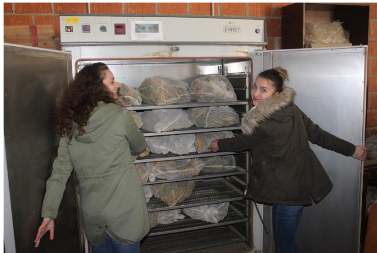
Slika 22: Sušenje poduzoraka u sušioniku. Izvor: Josip Leto
