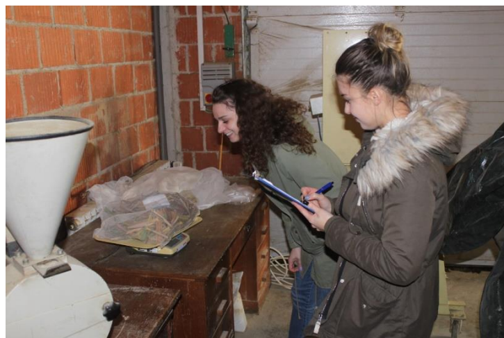
Slika 23: Vaganje poduzoraka prije i poslije sušenja. Izvor: Josip Leto
