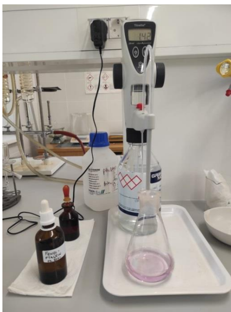
Slika 2. Mjerenje ukupne kiselosti destilata Izvor: slika autora rada
