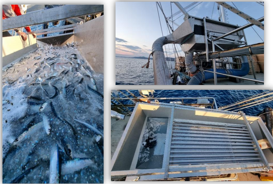
Slika 14. Prikaz selektiranja ulova na brodu „Galo“ sa selektorom (Izvor: Matulić, 2022.)
