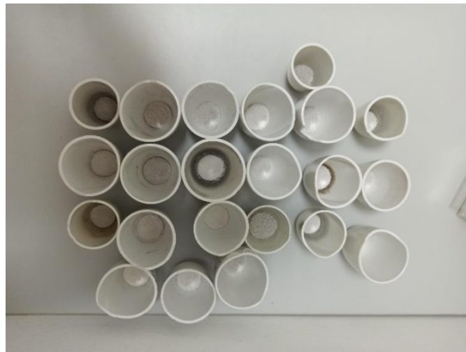
Slika 4.6. Posudice sa pepelom nakon izgaranja u mufolnoj peći
