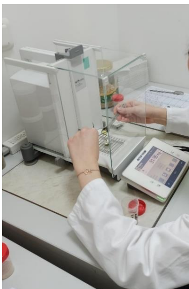
Slika 4.9. Priprema uzoraka za CHNS analizu
