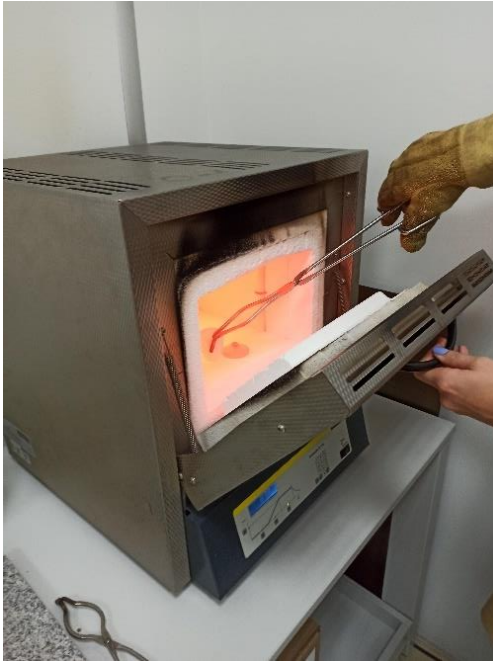
Slika 4.7. Stavljanje uzoraka u mufolnu peć
