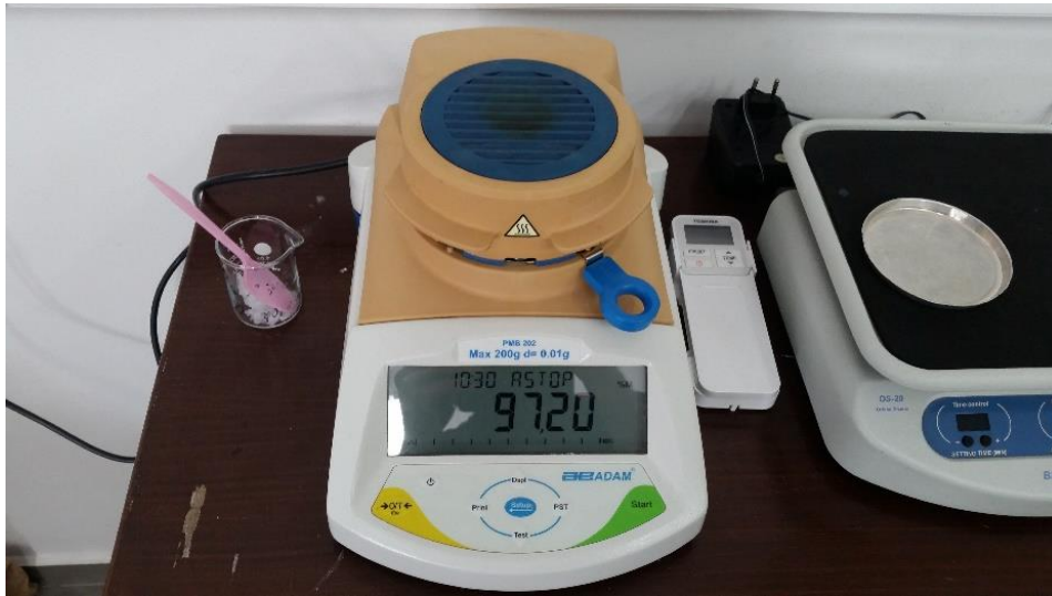
Slika 3.2. Vlagomjer za utvrđivanje količine suhe tvari (Snimio: M. Orešković)
