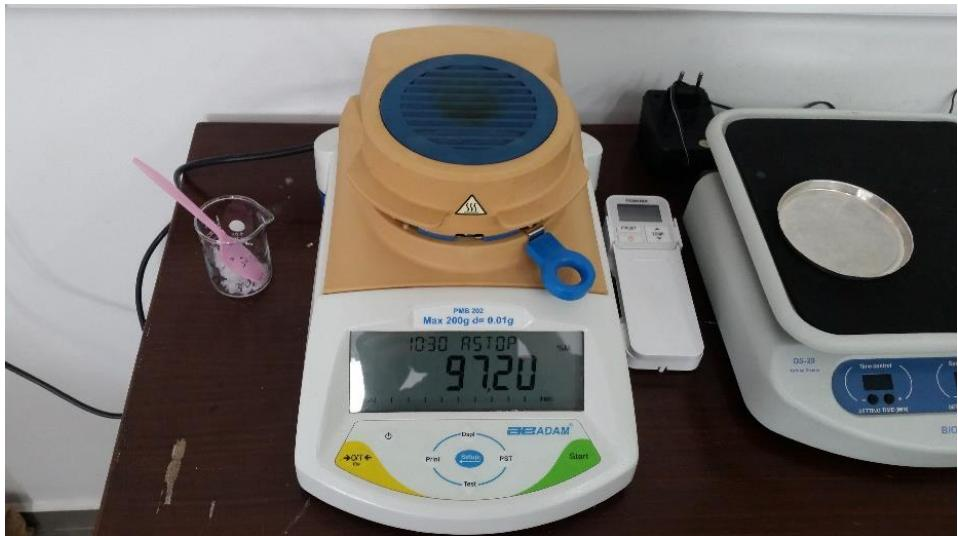
Slika 3.2. Vlagomjer za utvrđivanje količine suhe tvari
