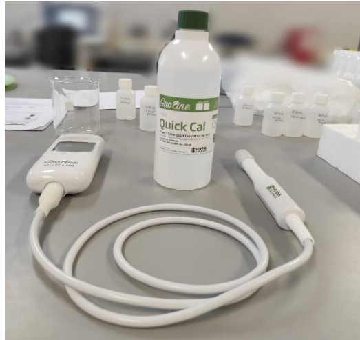
Slika 3.4.1.1. Groline HI9814 (Hanna instruments) uređaj za određivanje vrijednosti pH i električne vodljivosti u uzorcima vode.
