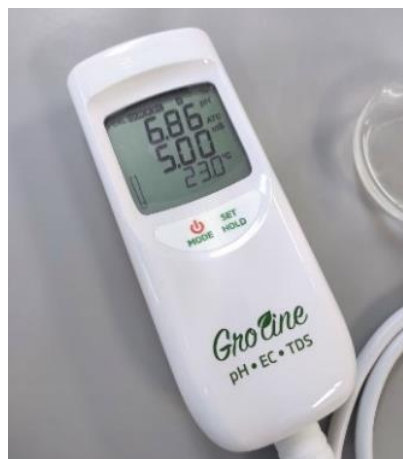
Slika 3.4.1.2. Očitavanje vrijednosti pH i električne vodljivosti (E.C.) u uzorcima vode iz rijeke Kupe na Groline HI9814 (Hanna instruments) uređaju.
