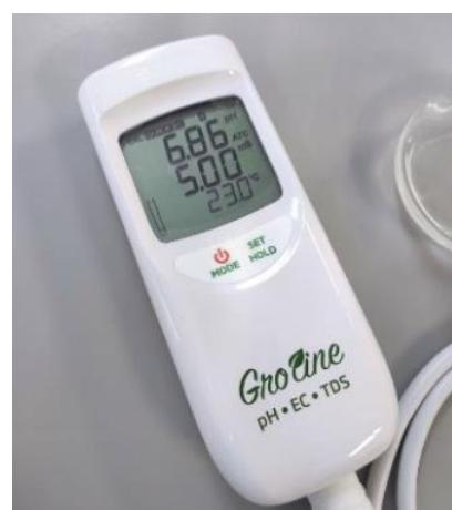
Slika 3.4.1.2. Očitavanje vrijednosti pH i električne vodljivosti (E.C.) u uzorcima vode iz rijeke Kupe na Groline HI9814 (Hanna instruments) uređaju.
