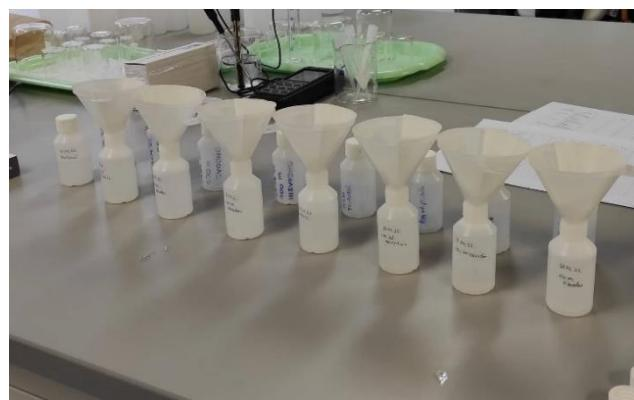
Slika 3.4.1. Filtracija uzorka vode uzetih iz rijeke Kupe.
