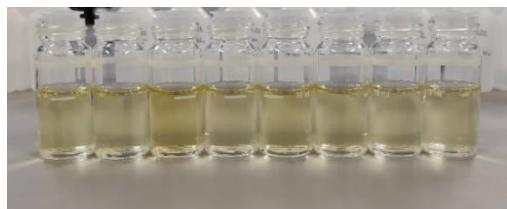
Slika 3.4.2.2. Uzorci vode iz rijeke Kupe s dodanim reagensima i u kivetama nakon očitanja koncentracija amonijačnih iona na fotometru (Hanna Instruments).
