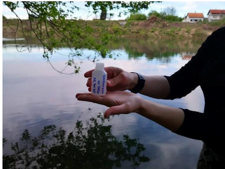
Slika 3.3.5. Uzimanje uzorka vode iz rijeke Kupe 1 m nizvodno od ispusta uređaja za pročišćavanje otpadnih voda.
