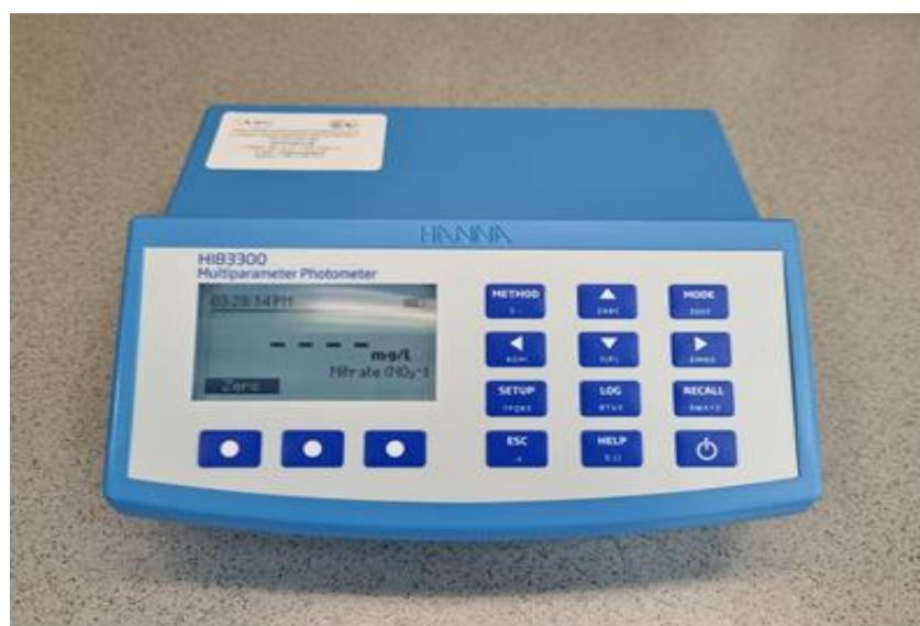
Slika 3.3.1.: Fotometar (HI83300 Multiparameter Photometer)
