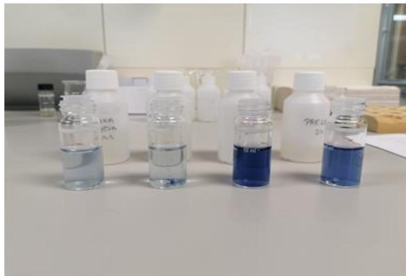
3.3.3.1.: Uzorci vode iz melioracijskih kanala s dodanim reagensima nakon očitanja koncentracije ortofosfata na fotometru
