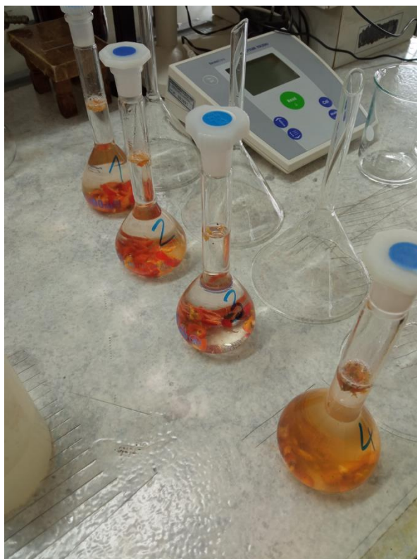
Slika 3.20. Priprema uzoraka za određivanje fenola (Autorica: Bosilj P., 2022)
