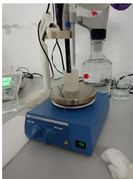
Slika 3.19. Elektroda uronjena u ispitivani uzorak (Autorica: Bosilj P., 2022)
