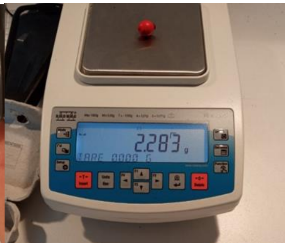
Slika 3.15. Analitička vaga (Autorica: Bosilj P., 2022.)
