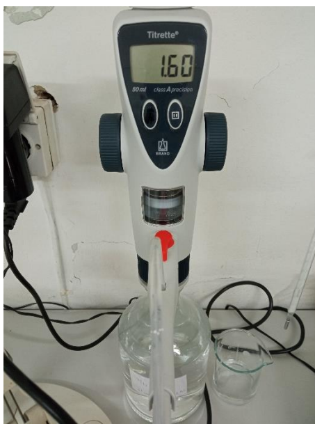
Slika 3.17. Utrošeni volumen (mL) NaOH tijekom titracije uzorka
