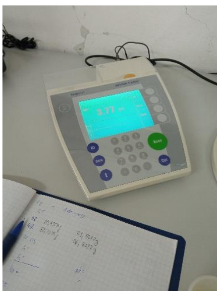
Slika 3.18. pH-metar (Autorica: Bosilj P., 2022)
