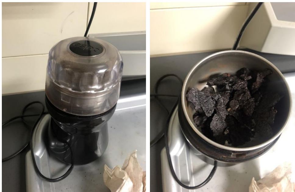
Slika 3.4.4. a) Blender mlin za mljevenje osušenih uzoraka plodova jagode b) detalj s uzorkom
