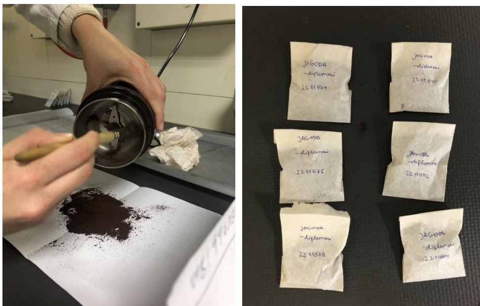
Slika 3.4.5. a) Odvajanje kistom osušenog uzorka ; b) Pakiranje osušenog uzorka u male papirnate paketiće za daljnju analizu
