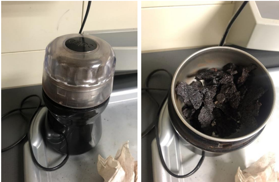
Slika 3.4.4. a) Blender mlin za mljevenje osušenih uzoraka plodova jagode b) detalj s uzorkom
