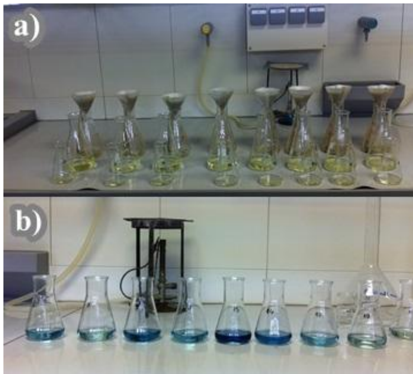
Slika 5. – Određivanje količine fiziološki aktivnih hranjiva. a) Dobivanje filtrata za određivanje fosfora i kalija; b) priprema otopine, iz filtrata, za određivanje fosfora
