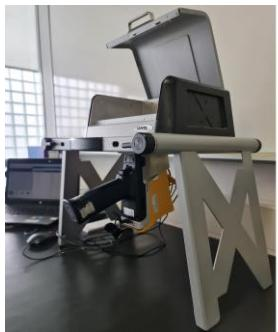
Slika 3.3.1. Olympus-Vanta C analizator
