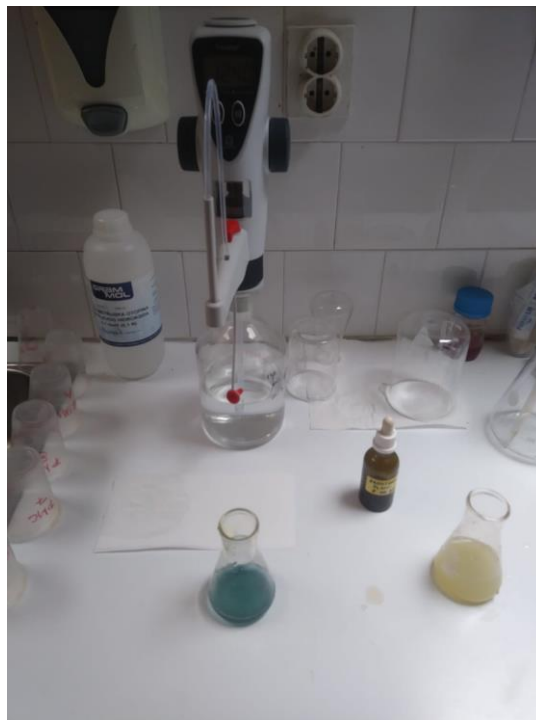
Slika 3.12. Mjerenje ukupnih kiselina 0,1M NaOH
