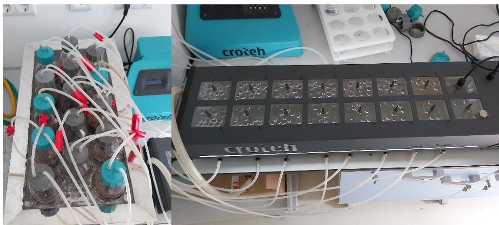
Slika 3.2.7.1. Bioreaktor za anaerobnu digestiju (vlastita arhiva)
