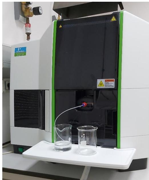
Slika 3.2.5.2. Atomski apsorpcijski spektrometar (vlastita arhiva)
