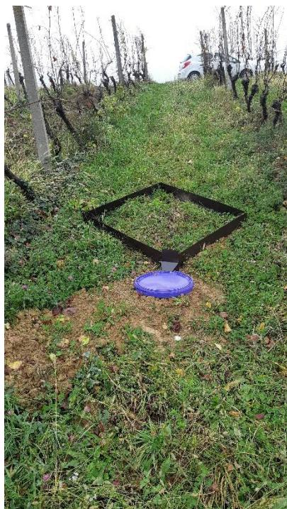
Slika 3.9. Prikaz sustava za površinsko otjecanje postavljen u međuredni prostor na istraživanoj lokaciji
