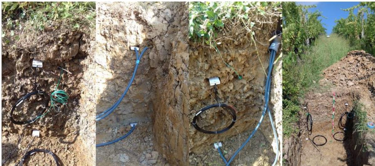
Slika 3.7. Postavljanje i položaj TDR senzora i tenziometra na P3 poziciji
