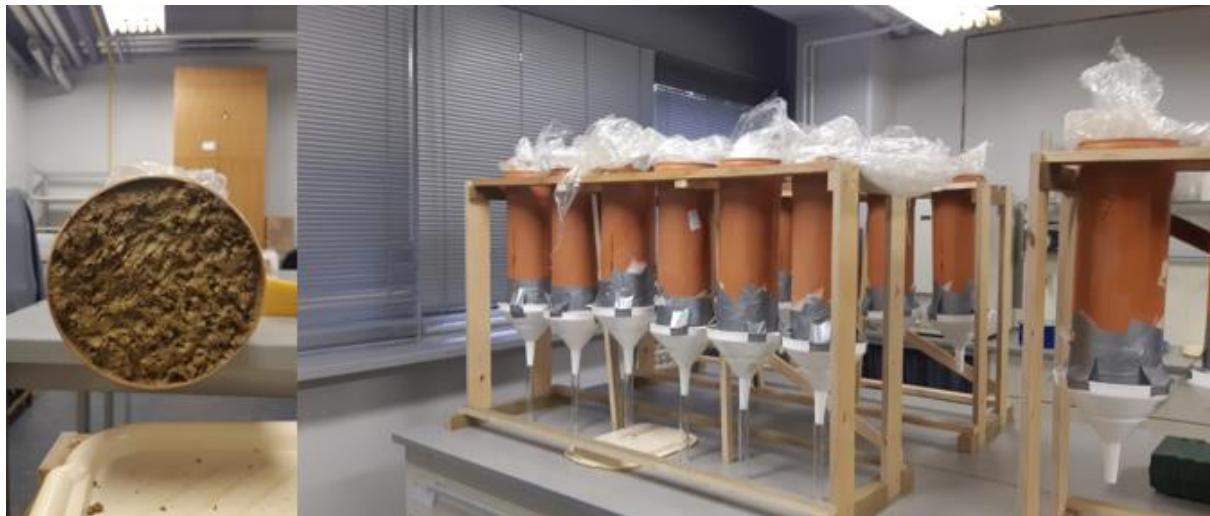
Slika 3.15. Priprema tla s kolonama i kolone tla tijekom analiza
