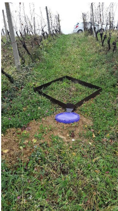
Slika 3.9. Prikaz sustava za površinsko otjecanje postavljen u međuredni prostor na istraživanoj lokaciji
