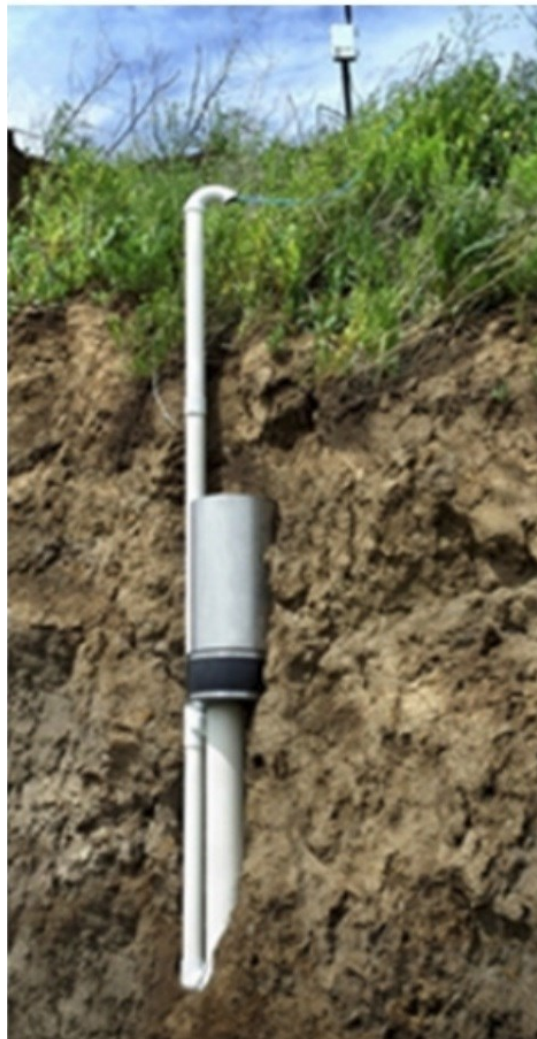
2.6.4. Pasivni kapilarni lizimetar ili tlačni lizimetar.
