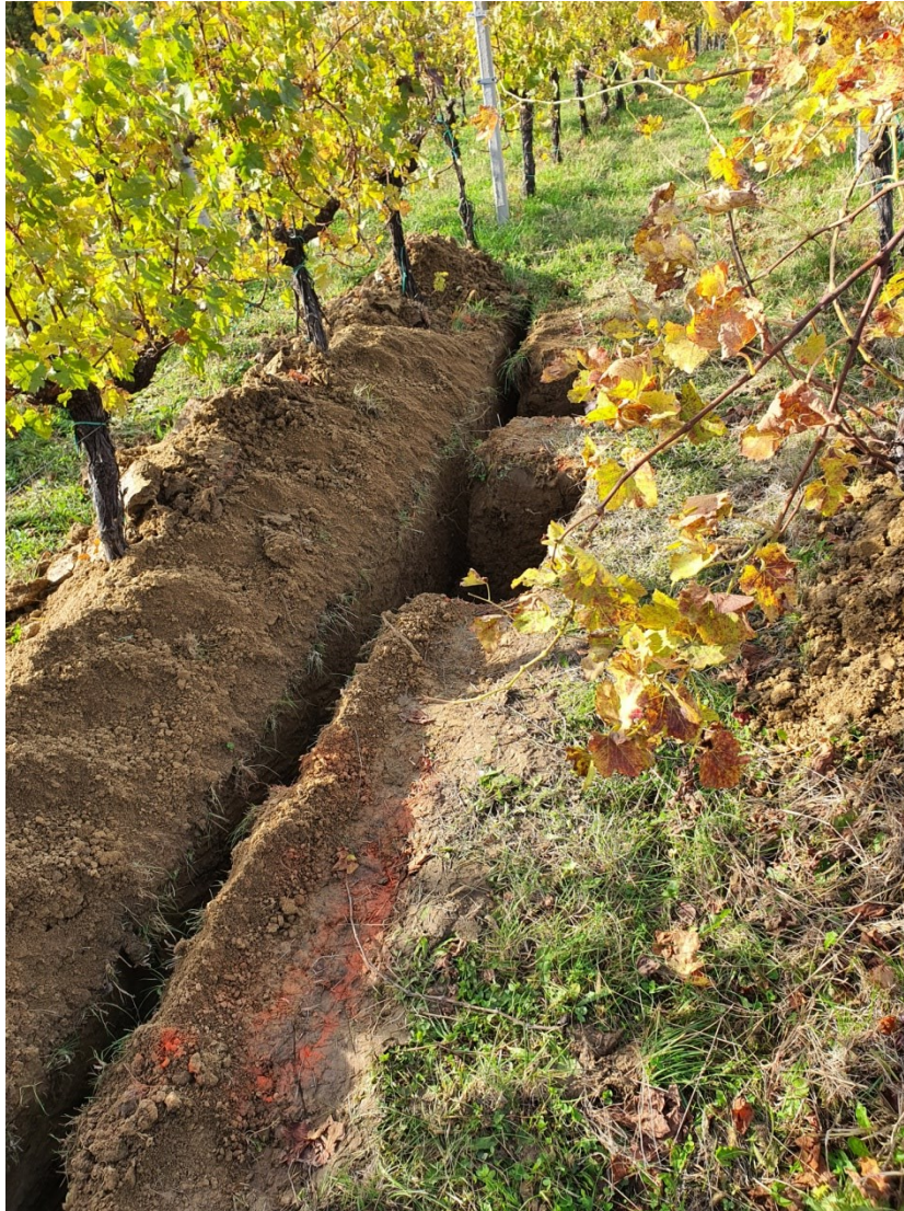
Slika 3.3.2. Iskop rupe za kompletan sustav tlačnih lizimetara. (Autentična fotografija 21. listopada 2020. Autor: Blanka Horvatić)
