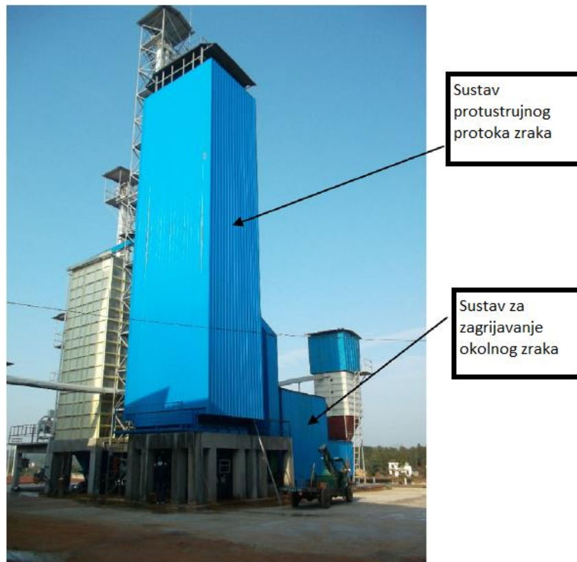
Slika 8. Prototip sušare s protustrujnim protokom zraka
