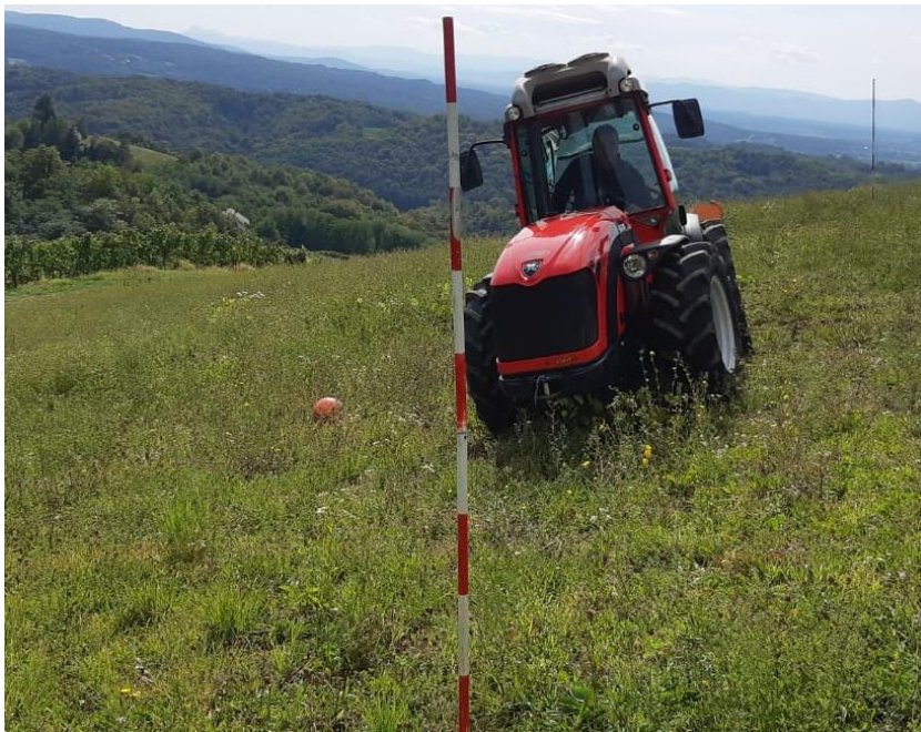
Slika 4.5. Održavanja pravca kretanja na bočnom nagibu Antonio Carraro SRX 9900
