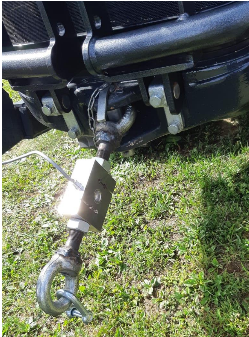
Slika 3.6. Dinamometar DHBM – S9M/50 kN
