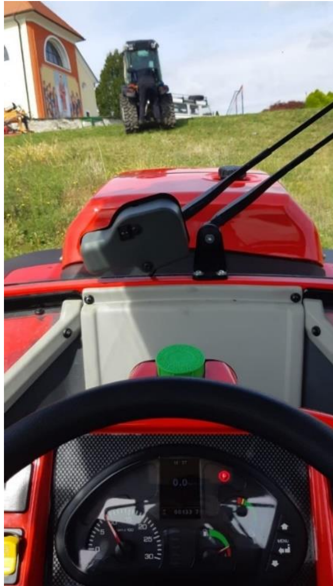
Slika 4.4. Ispitivanje vučne sile na uzdužnom nagibu (Antonio Carraro MACH 4 R)
