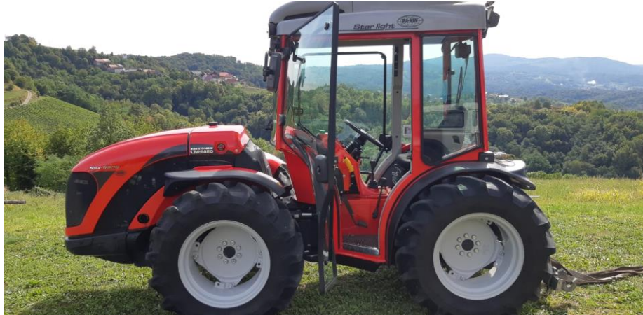
Slika 4.3. Ispitivanje vučne sile na uzdužnom nagibu (Antonio Carraro SRX 9900)
