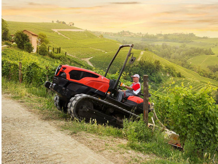
Slika 2.9. Voćarski traktor sa gumenim gusjenicama
