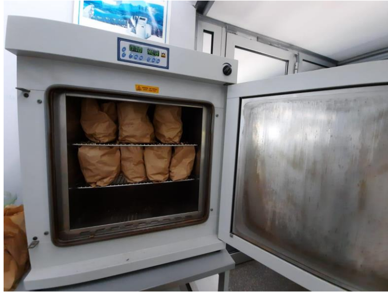
Slika 13. Sušenje uzoraka salate u sušioniku. Izvor: Alina Jantol
