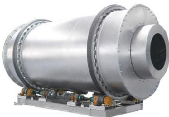
Slika 13. Shema direktne rotacijske sušare (Prilagođeno: Nordholm H. 2020)
