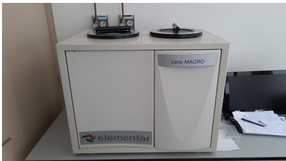
Slika 3.2.3. Vario, Macro CHNS analizator
