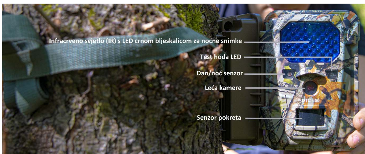
Slika 4. Senzorna kamera Minox DTC 650, jedna od kamera korištenih u ovom istraživanju
