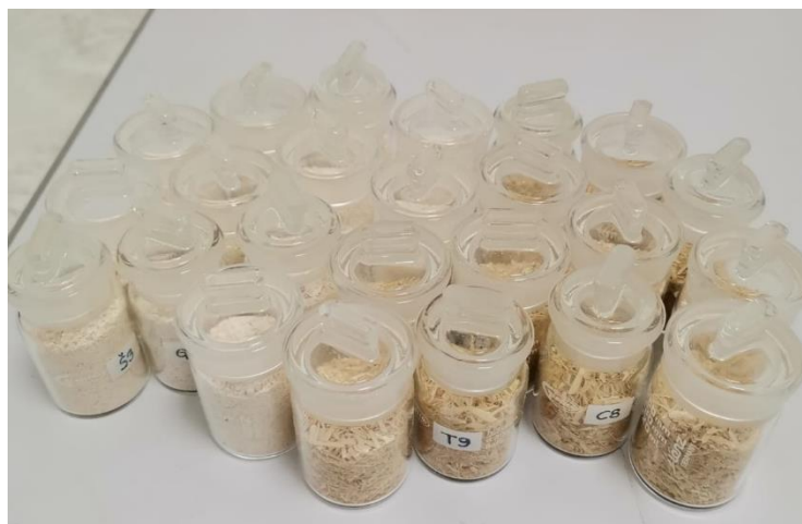
Slika 3.2.8. Posudice za vaganje sa uzorcima
