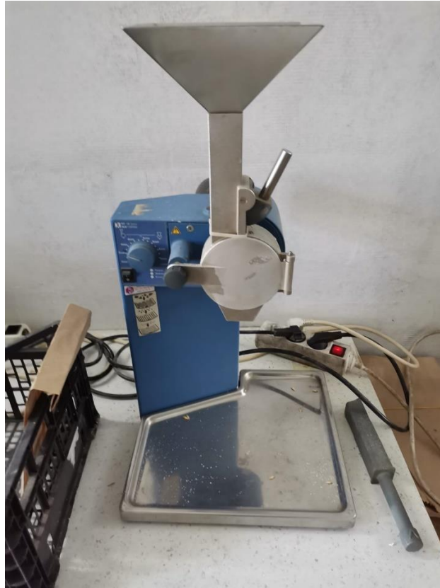
Slika 3.2.6. Laboratorijski mlin IKA MF 10 Izvor: Vlastita fotografija
