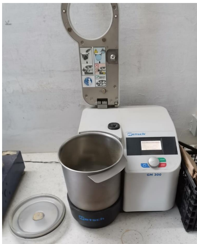
Slika 3.2.7. Laboratorijski mlin Retsch GM 300 Izvor: Vlastita fotografija
