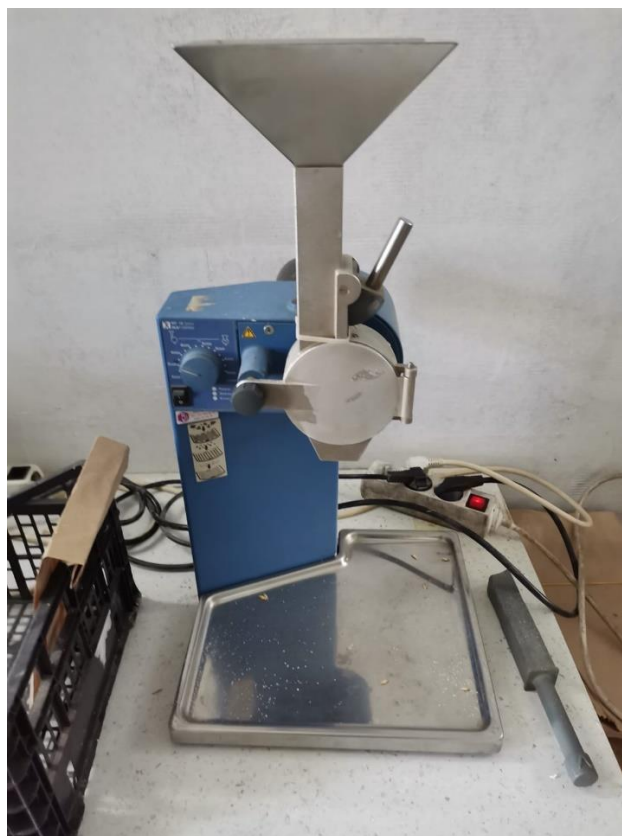
Slika 3.2.6. Laboratorijski mlin IKA MF 10 Izvor: Vlastita fotografija
