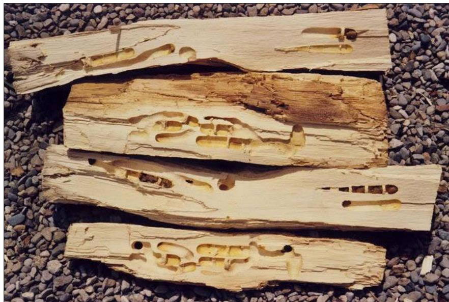
Slika 2.2.3.2. Presjek drveta u kojem je drvarica izbušila tunele za izgradnju gnijezda - razgranati tip gnijezda
