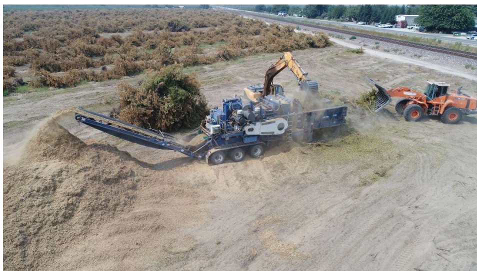
Slika 4. Usitnjavanje uklonjene biomase na mjestu uklanjanja
