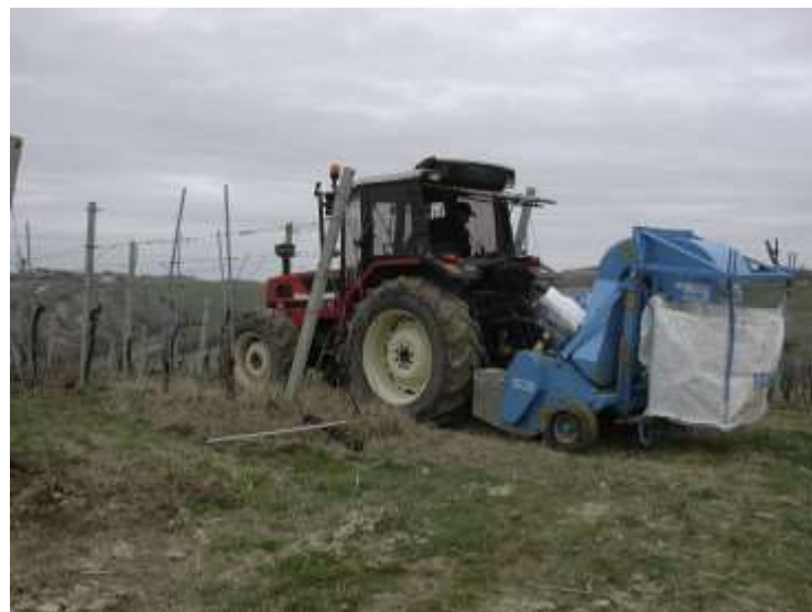
Slika 7. Sakupljač i drobilica orezanih ostataka (Spinelli i sur., 2009.)
